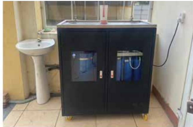
▲ Hình 2. Nhóm nghiên cứu vận hành, hiệu chuẩn máy lọc nước CDI tại phòng thí nghiệm
